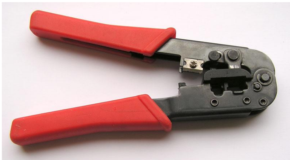
Рис.4. Інструмент (кримпер) для обтискання виті пари (коннектора 8P8C)
